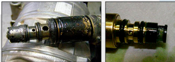
Válvulas de regulación con restos de suciedad.
